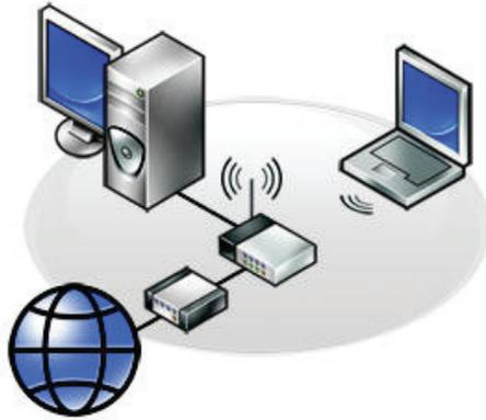
Les périphériques sont connectés sans fil et couvrent une zone relativement petite généralement limitée à une maison ou un bâtiment. La connexion sans fil utilisée pour la configuration WLAN est généralement une connexion Wi-Fi (802.11x).
