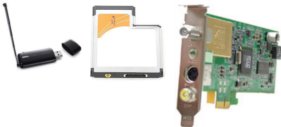
Les tuners TV sont généralement autonomes, mais certaines cartes vidéo sont équipées d'un tuner TV intégré.
